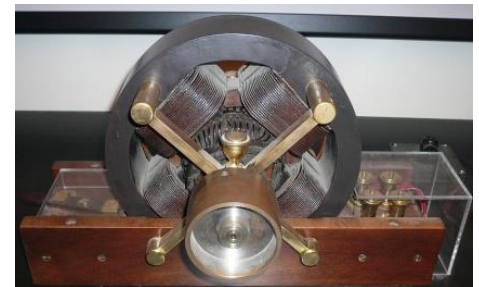
Asinhroni (indukcioni) motor Patent iz 1888 godine
