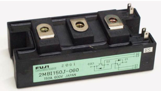
IGBT tranzistor 150A/600V(danas najčešće korišćen poluprovodnički prekidač snage)
