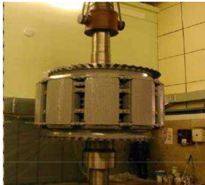
Izgled rotora sa isturenim polovima
